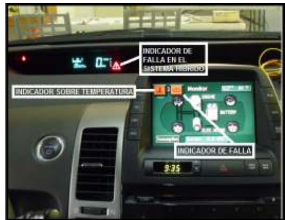
Fig. 16 Ejemplo de fallas en el sistema.
